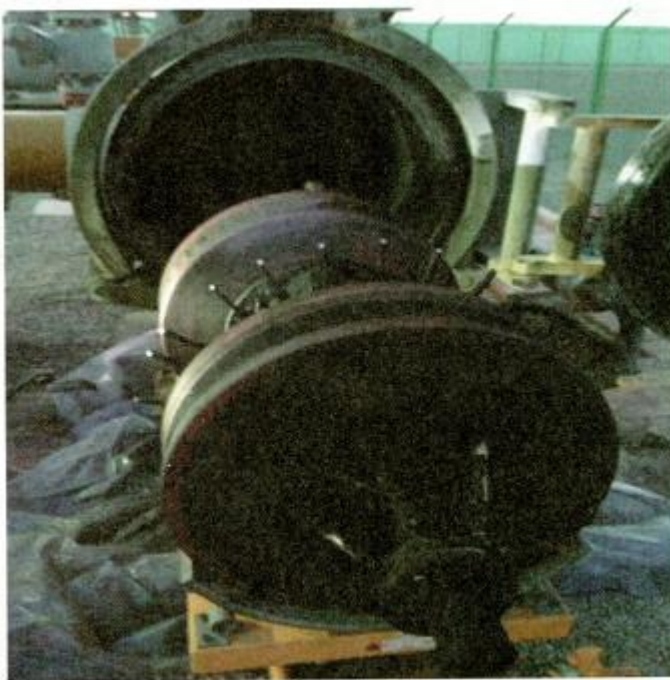
图 6-52 Φ660mm 变形检测器收球后状态图
