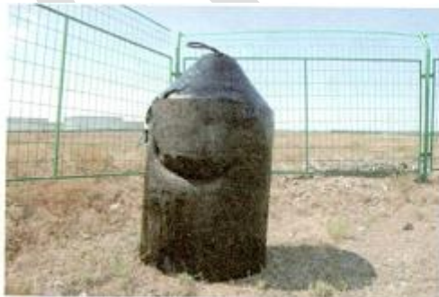
图 6-5 泡沫清管器破损图
