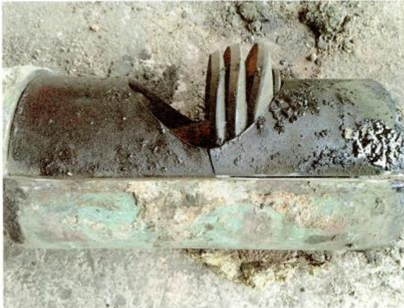
图 5.5 某管线中带压开孔无鞍形板造成的清管器卡堵
