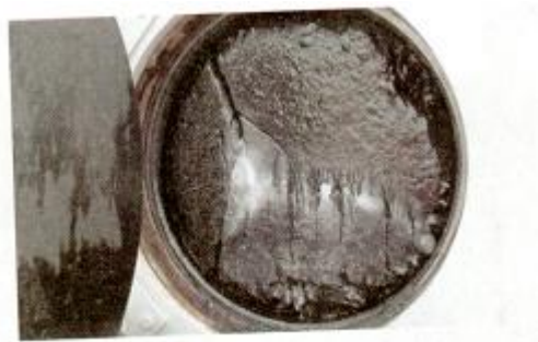
图 6-16 管道内清出的水合物
