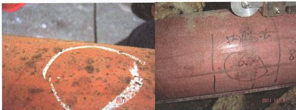
图 3.8 轻烃管线外腐蚀
