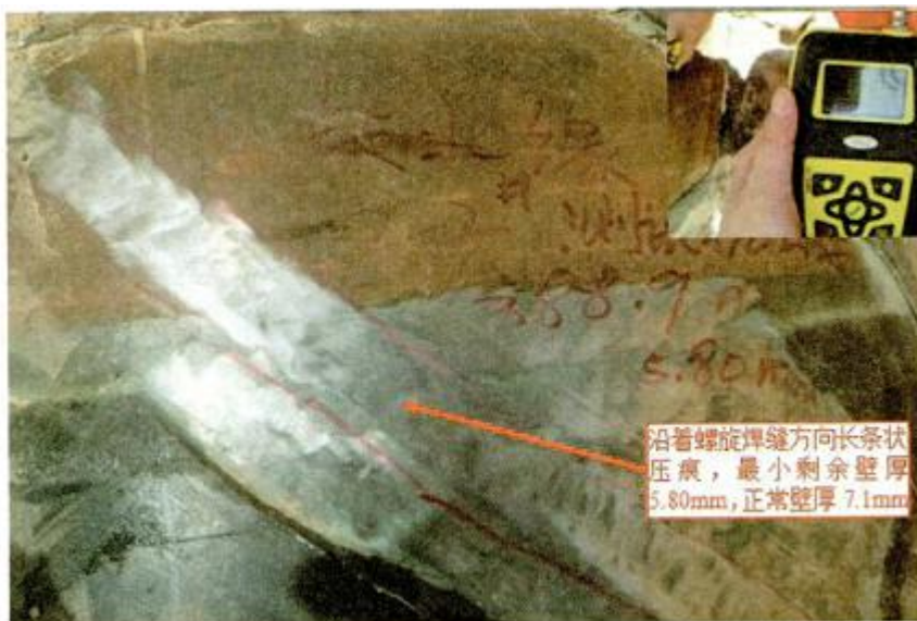
图 6-56 外壁制造缺陷开挖验证图
