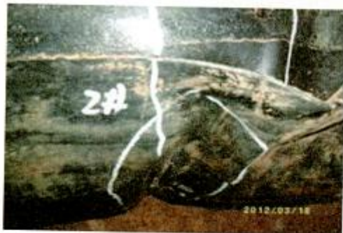
图 6-8 管道变形图
