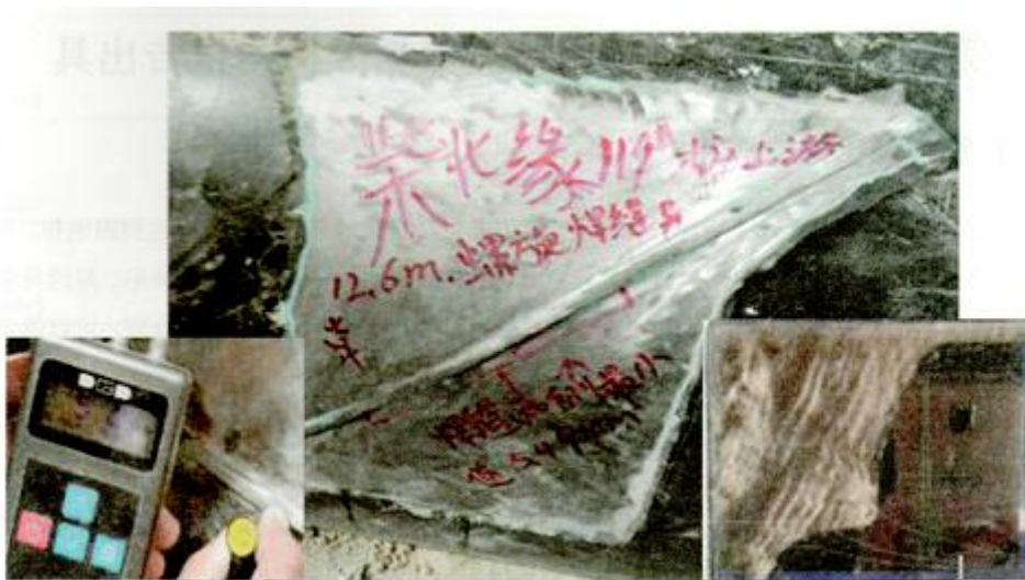
图 6-62 螺旋焊缝异常开挖验证图
