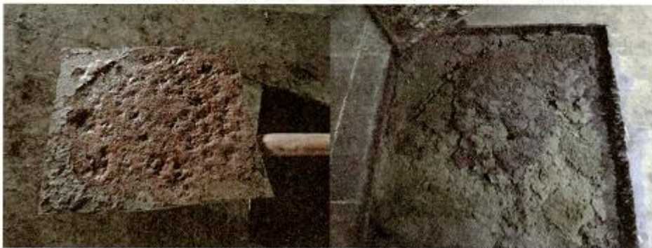
图 3.20 割板下表面腐蚀情况
