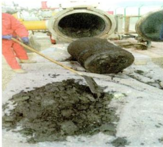
图 6-41 泡沫清管器清管情况
