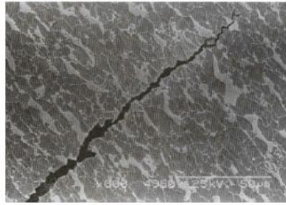
图 3-11 管线上的穿晶裂纹
