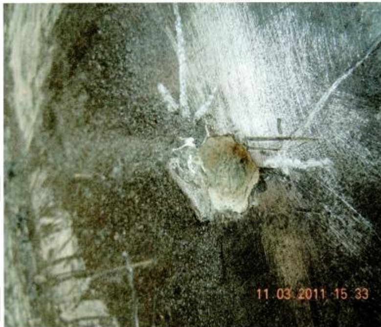
图 5.40 管体制造缺陷
