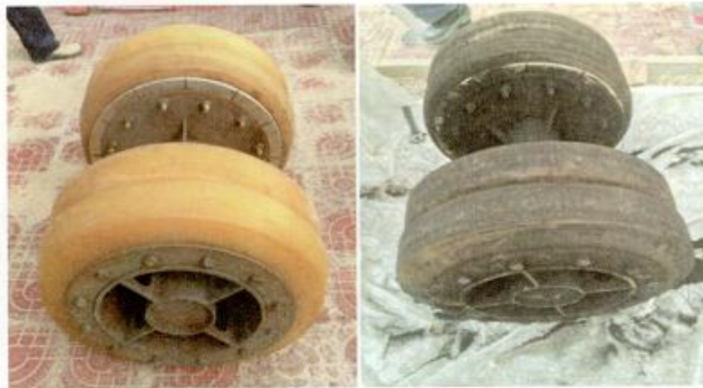
图 6-42 机械测径清管器发球前照片 图 6-43 机械测径清管器收球后照片
