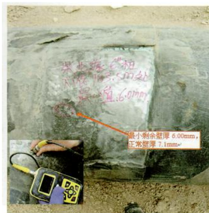
图 6-58 内壁缺陷开挖验证图
