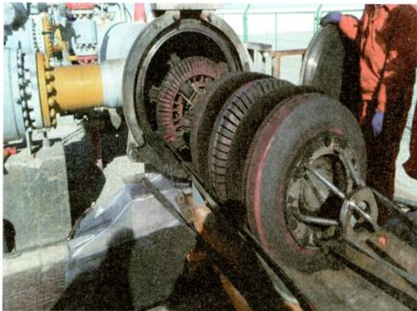
图 6-53 Φ660mm 漏磁检测器收球后状态图
