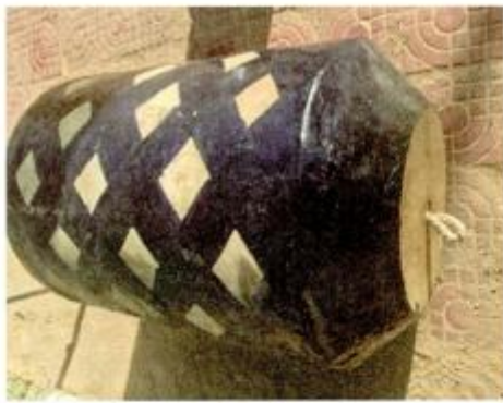
图 6-39 泡沫清管器发球前照片
