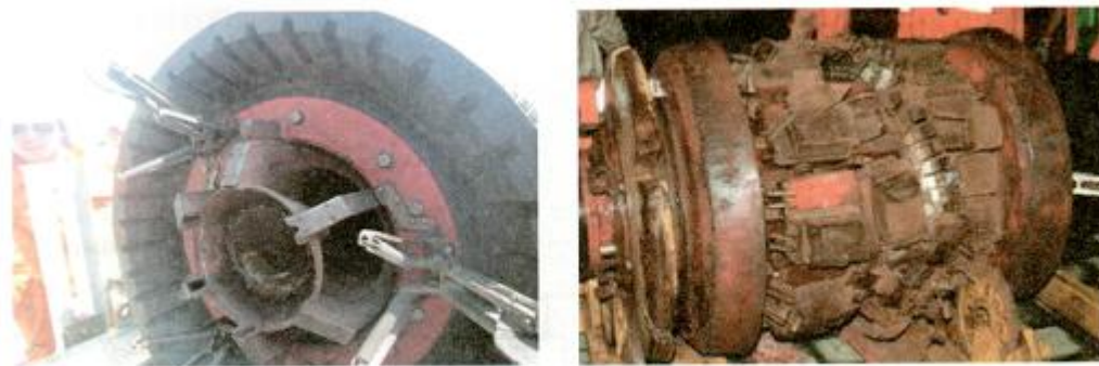
图 6-25 检测器部件脱落
