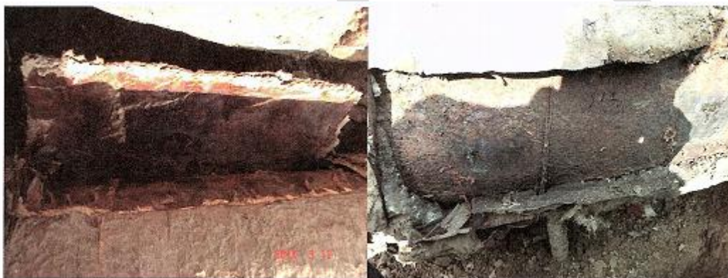
图 3.12 埋地管道保温层下腐蚀
