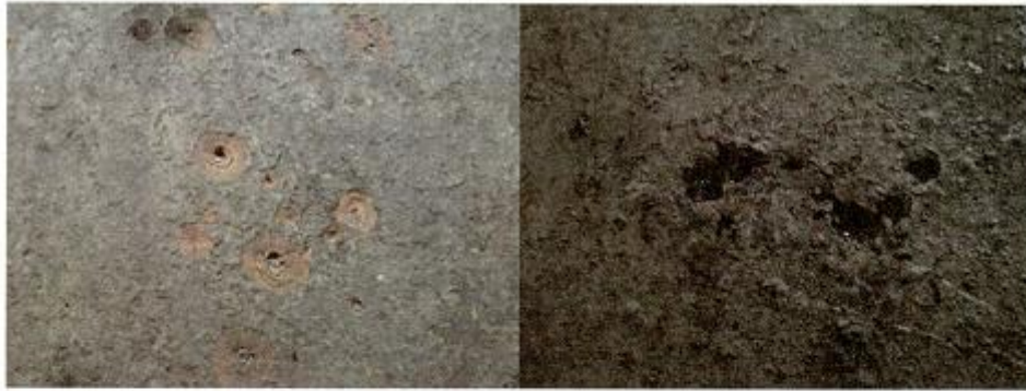
图 3.18 底板上表面腐蚀
