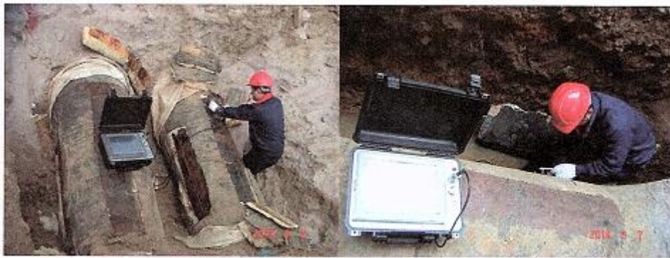
图 3.11 开挖管道漏磁外检测现场
