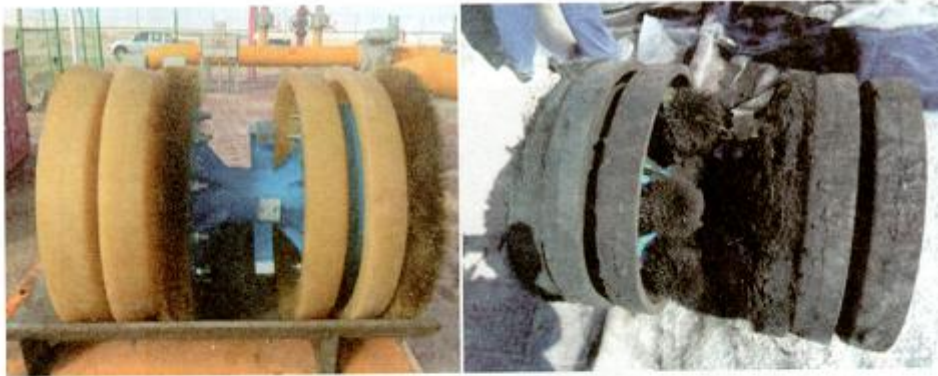
图 6-48 磁力钢刷清管器发球前照片 图 6-49 磁力钢刷清管器收球后照片
