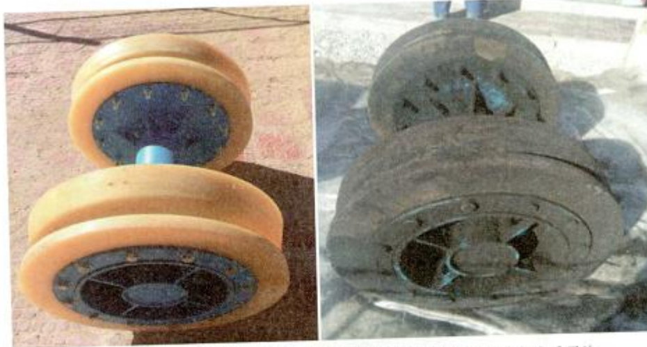
图 6-45 两直两碟清管器发球前照片图 6-46 两直两碟清管器收球后照片
