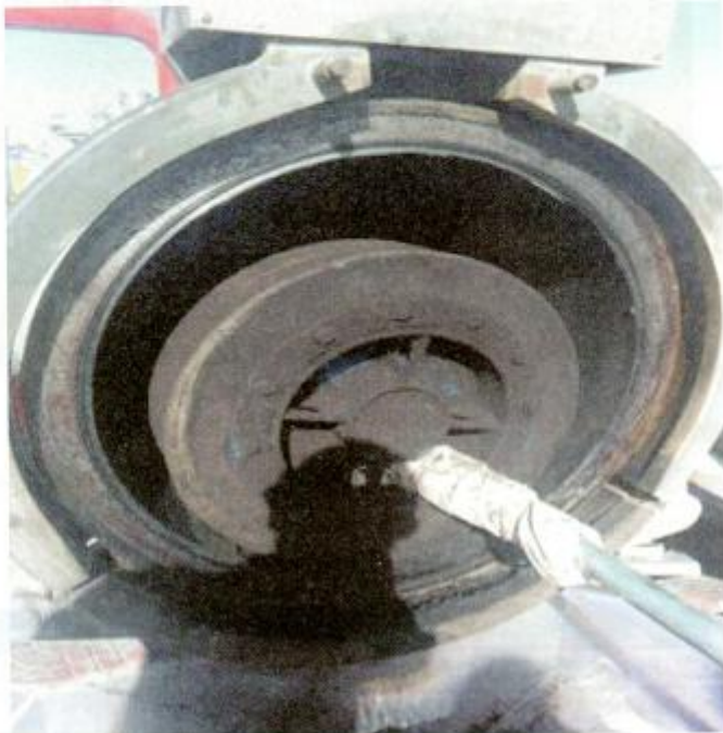
图 6-50 磁力钢刷清管器清管情况
